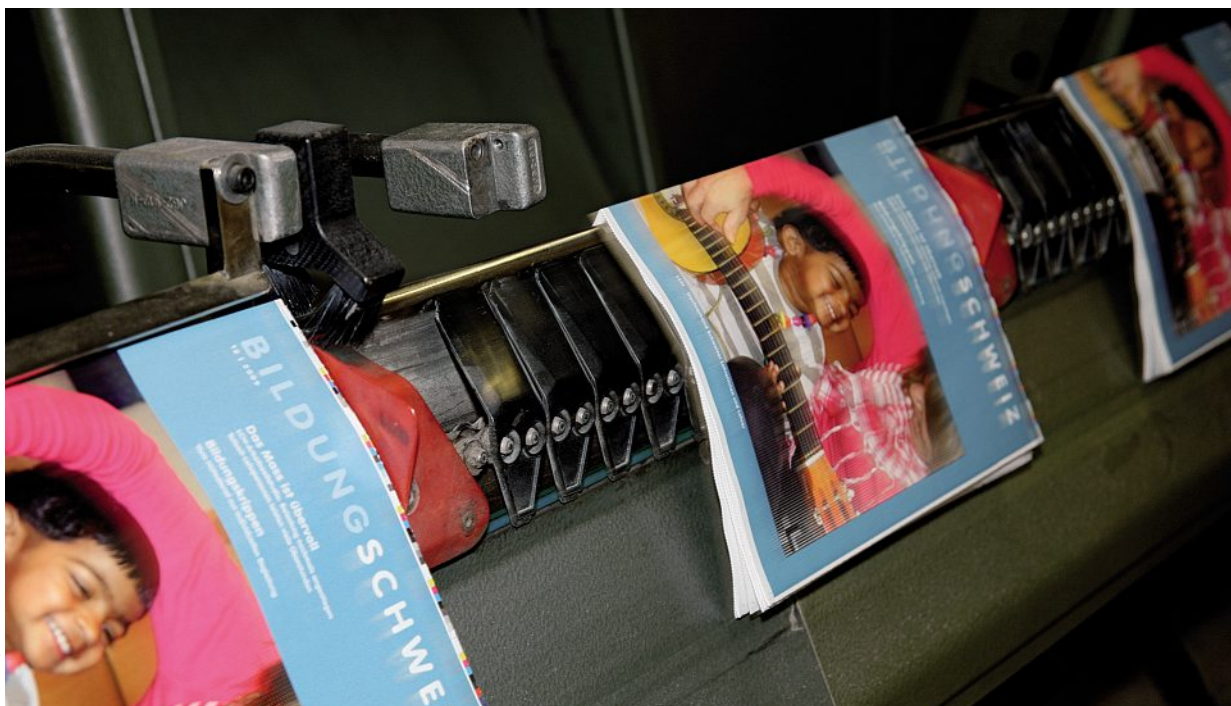
Die 16-seitigen Bogen werden von der Ausrüstmaschine zu vollständigen Heften zusammengetragen. (Bericht dazu Seite 12)
