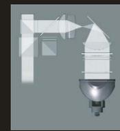
Die horizontale Lichtkomponente wird parallel zum optischen System für Farbseparation und -kombination übertragen, um einen hohen Kontrast zu erzielen.
