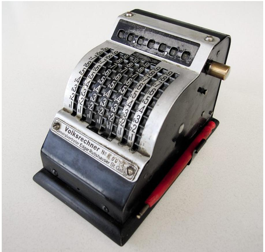
Stellradgriffel-Addierer mit Subtraktion und automatischem Zehnerübertrag aus den 1930er Jahren.
